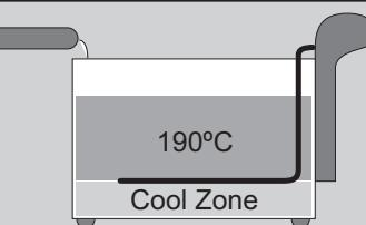
Dieser Frittiertyp ist nur für die Verwendung mit Öl oder flüssigem Fett geeignet, nicht jedoch für festes Fett. Bei der Verwendung von festem Fett besteht die Gefahr, dass Wasser im Fett eingeschlossen wird, das beim Erhitzen zu heftigen Spritzern führt.
