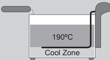
Questo tipo di friggitrice è adatta solo per l'uso con olio o grasso liquido e non con grasso solido. L'utilizzo di grasso solido comporta il rischio di intrappolare acqua nel grasso che, una volta riscaldato, ne farà schizzare violentemente.
