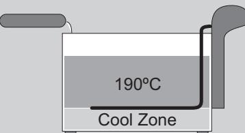
Ce type de friteuse ne convient qu'à une utilisation avec de l'huile ou de la graisse liquide, et non avec de la graisse solide. L'utilisation de graisse solide comporte le risque d'emprisonner de l'eau dans la graisse, ce qui la fera éclabousser violemment lorsqu'elle est chauffée.
