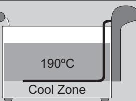
Dit type friteuse is alleen geschikt voor gebruik met olie of vloeibaar vet, en niet voor vast vet. Het gebruik van vast vet brengt het risico met zich mee dat er water in het vet blijft zitten, waardoor het bij verhitting heftig gaat spatten.
